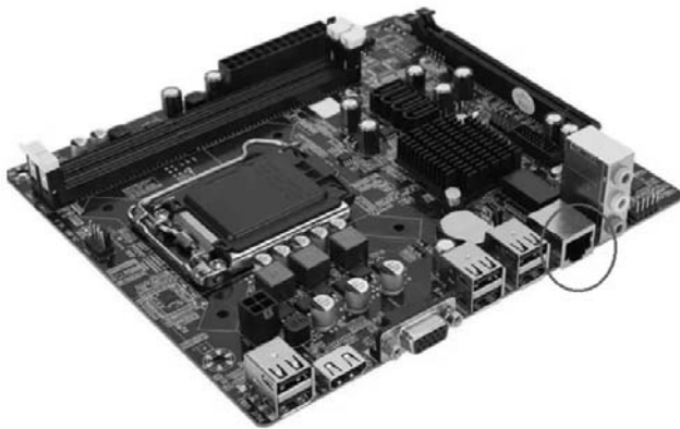
Tarjeta de red Ethernet integrada en la placa base de un PC
