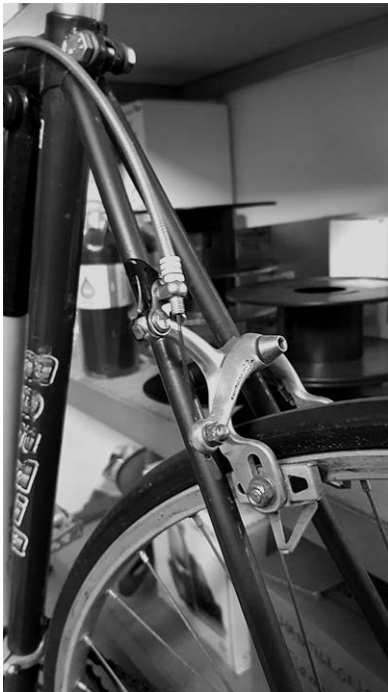
Cable de freno Bowden en una bicicleta de carreras
